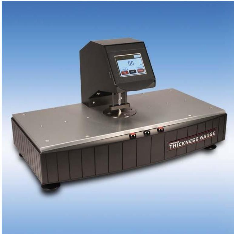
Misuratore di spessore con accuratezza di misura di 0,4 microns e risoluzione 0,1 microns. Pienamente compatibile con le principali normative ISO, ASTM, DIN, BS e TAPPI per la misura dei più svariati substrati tra cui film, carta, cartone, fogli e tessuti etc.
