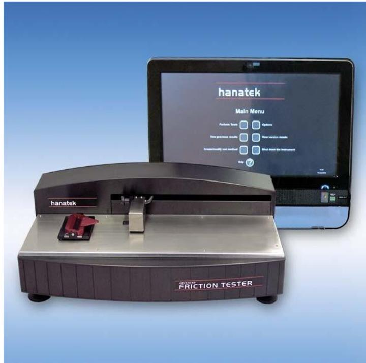
Misuratore di Coefficiente di Attrito (COF) **dinamico e statico** per materie plastiche, film, substrati da imballaggio, carta e cartoni stampati in conformità con le principali normative BS, ISO, ASTM, TAPPI e FINAT.
