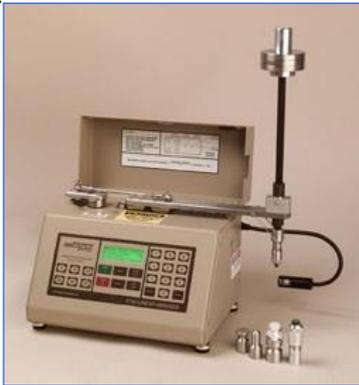
La velocità della barra porta abrasivo può essere variata da 2/75 cicli al minuto. **Taber 5750** utilizza speciali mole abrasive **Weraser** fatte con le stesse caratteristiche delle mole utilizzate negli abrasimetri rotazionali
